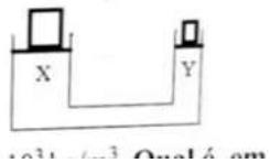
O princípio de Pascal afirma que a pressão aplicada a um fluido confinado é transmitida igualmente a todos os pontos do fluido. Na prensa hidráulica, a pressão em X é igual a pressão em Y
